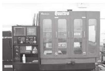
図5-3 CNC 旋盤
